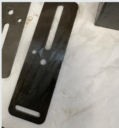
Behandlung mit Retomax **Protect** PT10 und **DegreasePlus** DG31 über 30 Minuten bei 50 °C und 6% iger Retomax Lösung und Fluxen
