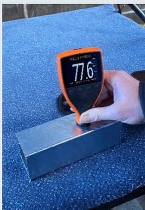
Schichtdicke min. 50 µm
