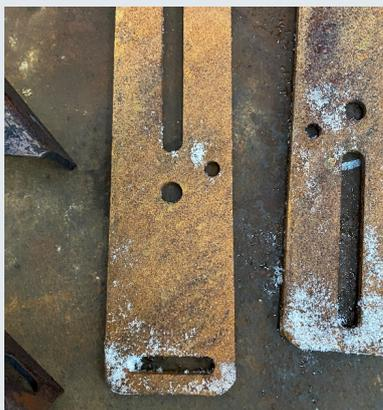
Die Werkstücke wurden im Außenbereich über längere Zeit gelagert und weisen dementsprechend starke Korrosion auf
