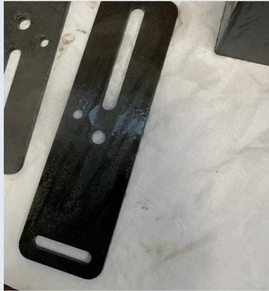
Behandlung mit Retomax **Protect** PT10 und **DegreasePlus** DG31 über 30 Minuten bei 50 °C und 6% iger Retomax Lösung und Fluxen
