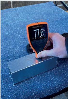
Schichtdicke min. 50 µm
